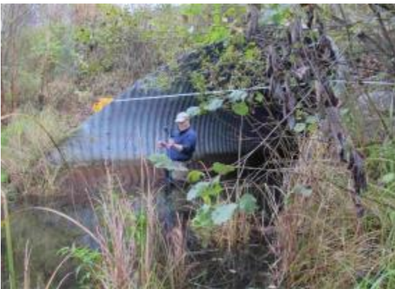
Kuva 1. Uiherlanjoen virtaamamittausta 27.9.2012. Ennen virtaamamittauksia mittauslinja puhdistettiin kasveista ja suurimmista kivistä puhtaaksi.
